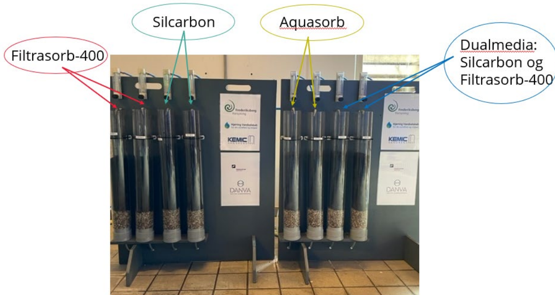
Figur 1 Kolonneopstilling på Frederiksberg Forsyning. Der var 8 kolonner i alt med hver 800 g aktivt kul. Typene af aktivt kul, der blev testet, er markeret i cirklerne på figuren. Hver type af kul blev testet i replikat.
