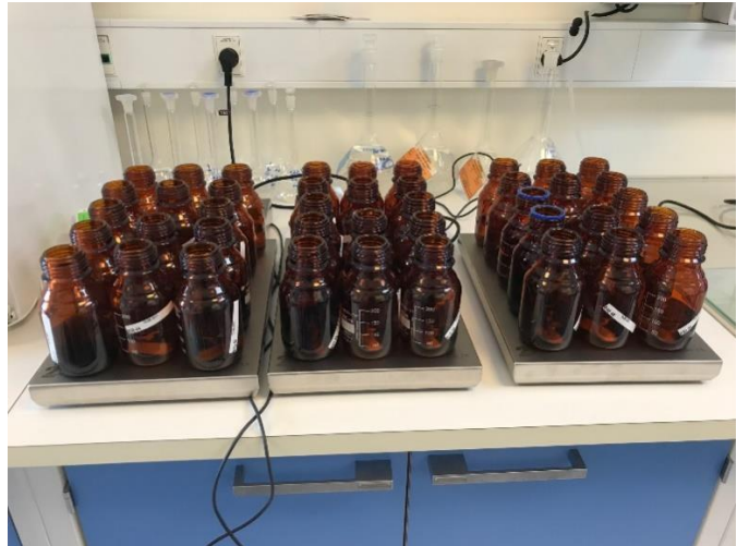
Figur 2. Sorptionsforsøg i HOFORs vandkvalitetslaboratorium. Til venstre: Opsætning af flasker med forskellige produkter; Til højre: Forsøgsopstilling med flasker på magnetomrører.
