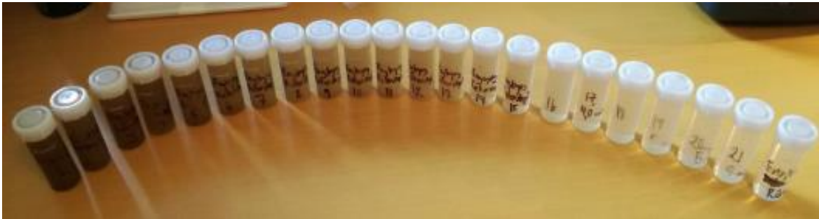
Figur 7: Returskyllevandsprøver udtaget for hver 15-30 sek under returskyllning med vand. Foto: Ditte Andreasen Søborg.
