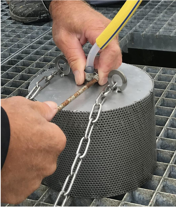
Figur 3: Kurv, der fungerer som grovfilter, sænkes ned i vandet og monteres med kæder. Den monterede slange er forbundet til indfødningspumpen. Inderste slange er af silikone. Den yderste slange er af PVC og fungerer som mekanisk beskyttelse og som lysbarriere for at undgå algevækst i slangen.
