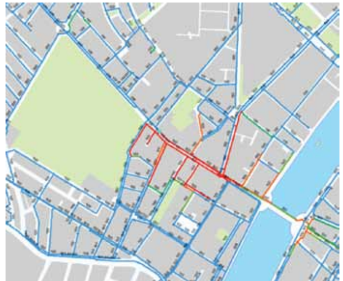
Forureningsramt område på Nørrebro med reparationssted som kilde til forureningen. Resultat fra ledningsnetberegning. Ledninger med blå farve indeholder ikke forurennet vand.
