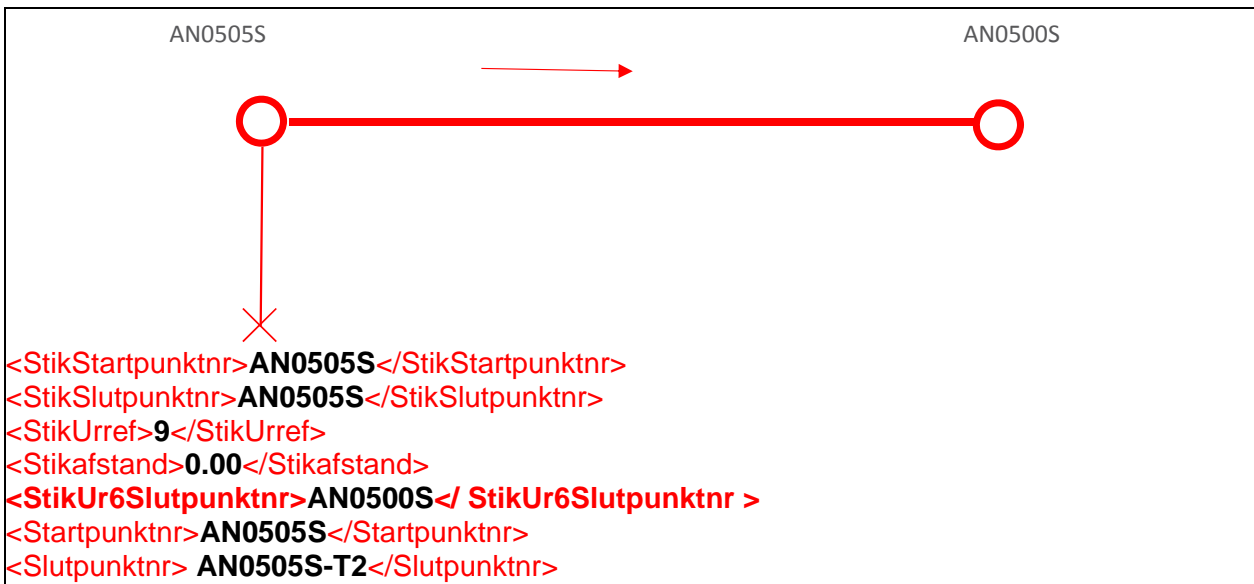
Figur 6.5: Eksempel på identifikation i XML-fil for stikTV på brøndstik
